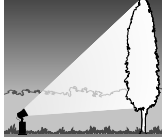
ÓPTICA LAMA DE LUZ (a obtener con refractor)
