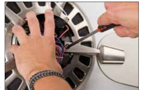
Encaje de pala al motor Blades assembly to motor
