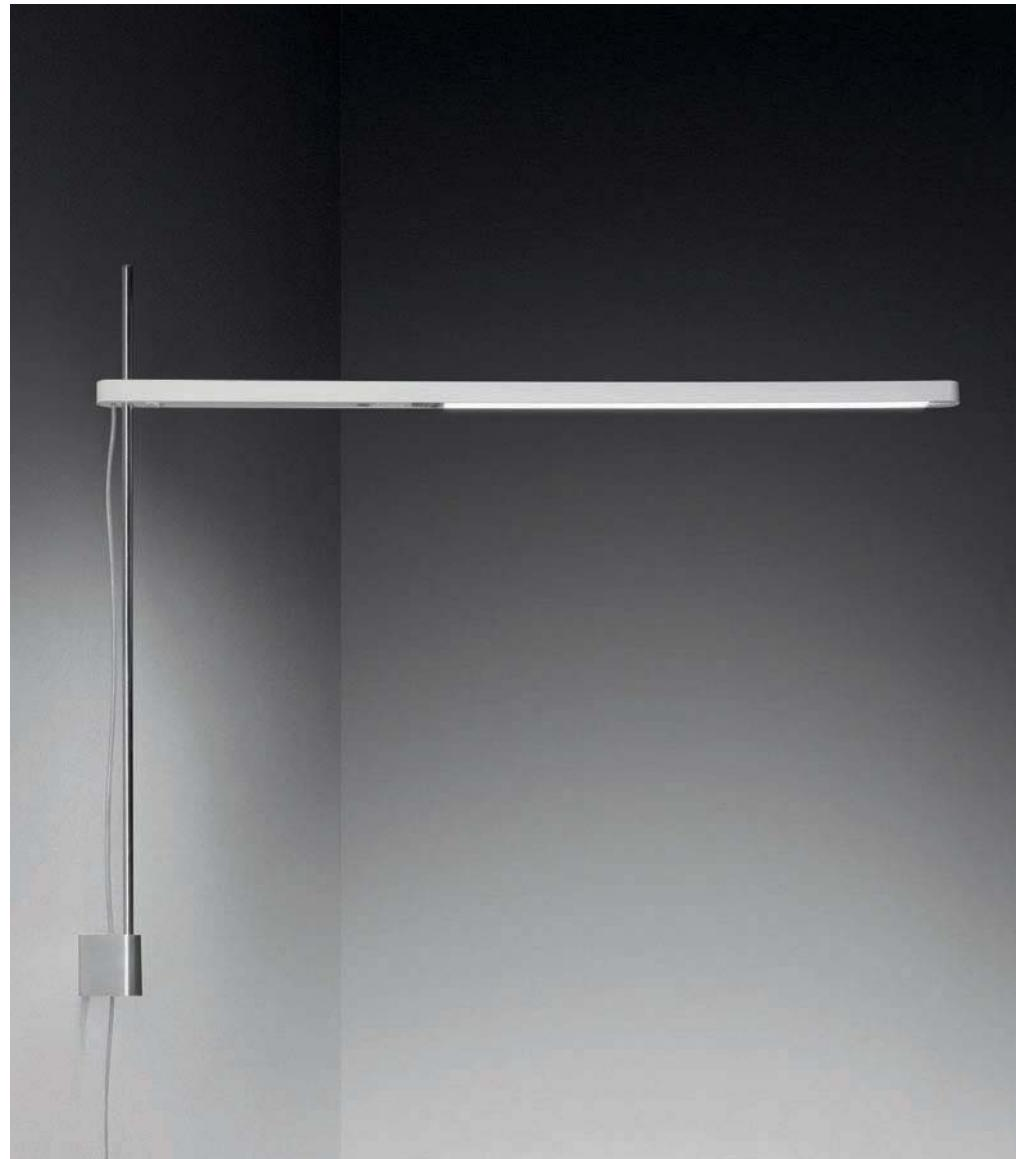
**Materiali:** struttura in acciaio flessibile verniciato, rivestita da una guaina in silicone platinico naturale (anti ingiallimento); attacco parete e diffusore in policarbonato trasparente verniciato effetto gomma; riflettore in alluminio speculare con microforature irregolari; fondello in acciaio verniciato.
