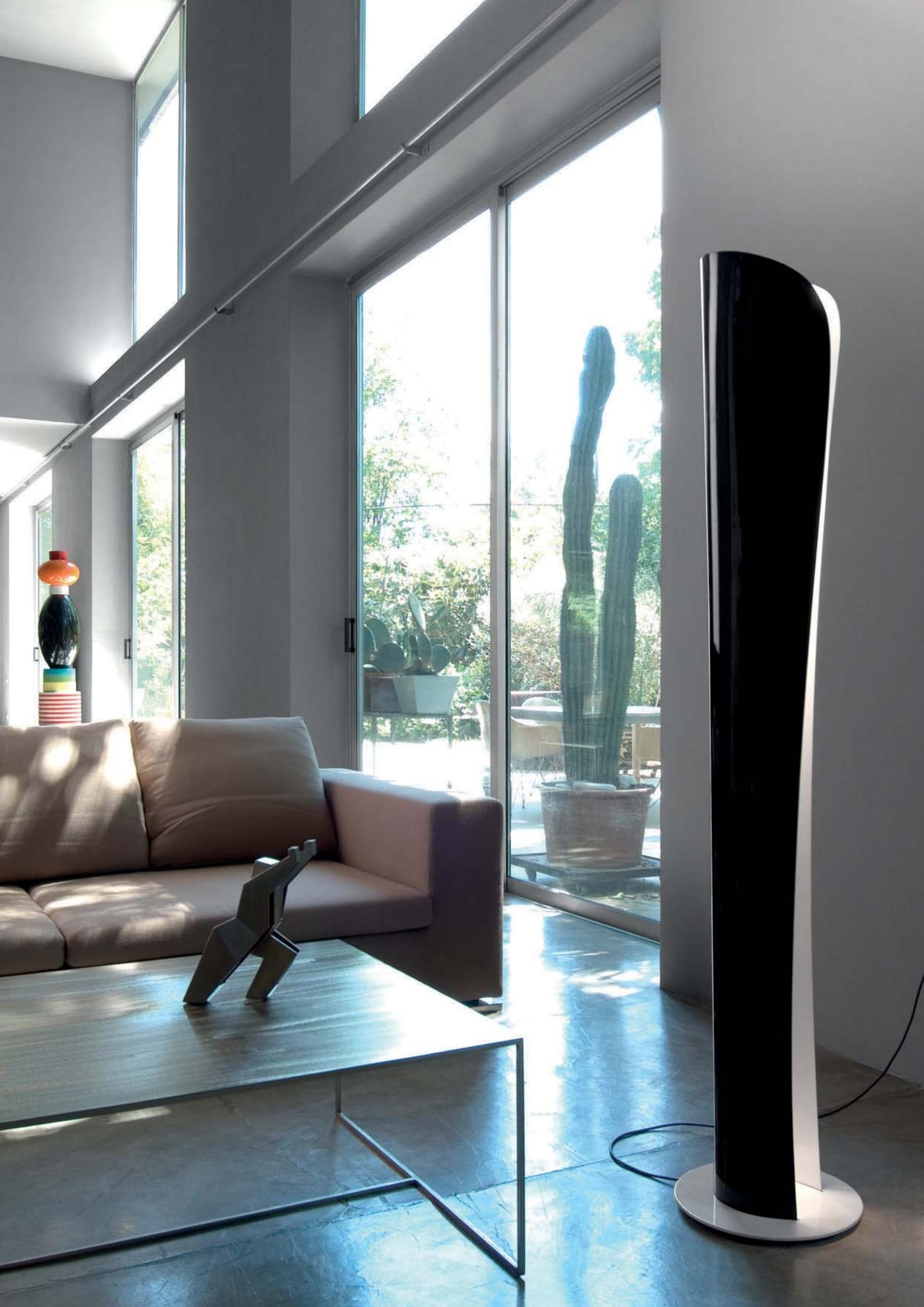
**Materiali:** base e struttura in alluminio pressofuso; stelo in acciaio; diffusore in alluminio stampato e trattato a specchio.
